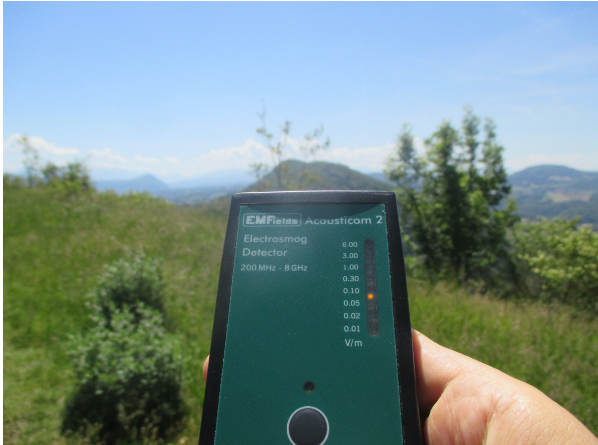
L' Acousticom est un appareil mesurant différents champs électro-magnétiques
